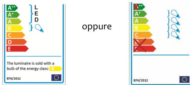
Nei due casi sopra abbiamo la dichiarata compatibilità dell'apparecchio con sorgenti efficienti (LED integrati nel primo caso, lampade di classe A+ sostituibili dall'utente finale nel secondo) ma avendo più attacchi lampade, hanno anche la compatibilità dichiarata con lampade meno efficienti del limite imposto dall'emendamento.
